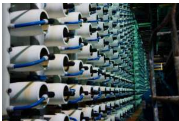
Filtres de dessalement de l'eau de mer par osmose inverse à Ashkelon / Veolia, la plus grosse usine du monde.
